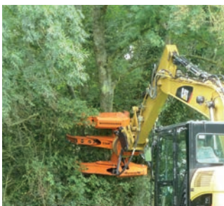
Pince WESTTECK C350 Sur pelleuse (faible tassement). Diamètre de coupe : 35-40 cm.
