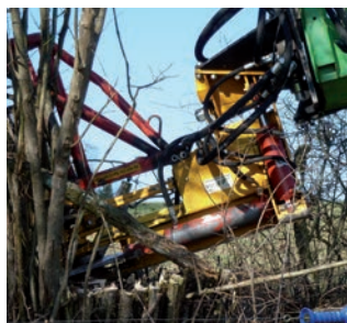
Cisaille ESCOMEL moyenne taille. Diamètre maxi : 18 cm bois dur, 25 cm bois tendre
