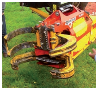
Pince XYLOCUT (société Rabaud) Diamètre de coupe : 30 cm. Sur télescopique (risque de tassement de sol).
